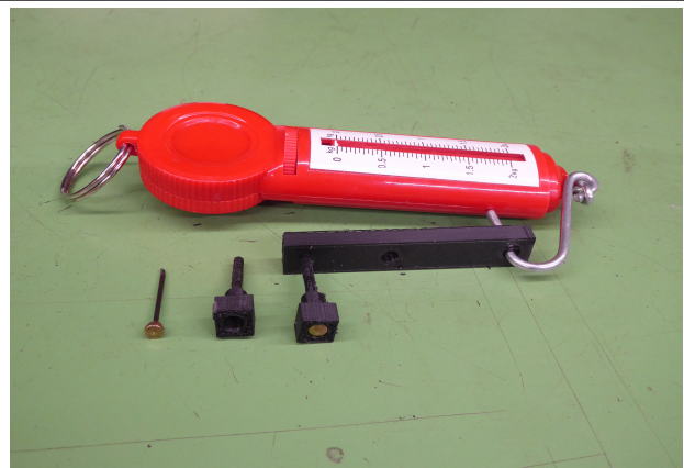
Fig. 7: Test Setup mit Hebel, Zug nach oben
